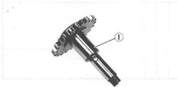
**PUMP GEAR SHAFT**
